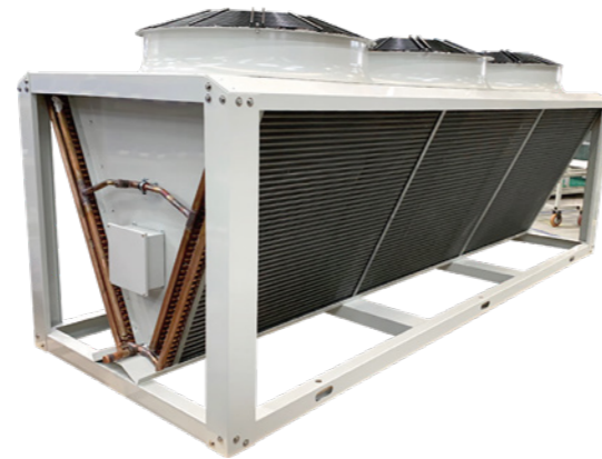
900mmV 型冷凝器 风机数量：2~3 个 换热量：97~259.7kW
